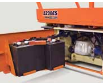
ประตูแบตเตอรี่เหล็กแบบเปิดออกพร้อมบานพับสำหรับงานหนัก
