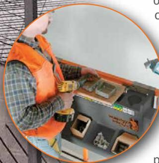
El enchufe de 12 V opcional está conectado a las baterías del elevador de tijera para proporcionar energía a la herramienta o el cargador de teléfono proporcionados por el cliente.
