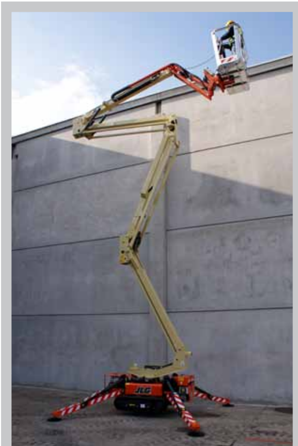
รถกระเช้าตีนตะขาบขนาดเล็กมีอยู่ทั้งหมดสามรุ่น
