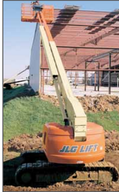
รุ่น 600 Crawler Series มาพร้อมกับตีนตะขากเหล็กสำหรับทุกรุ่น
