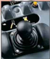
การยก/การแกว่ง คันโยกควบคุมที่ สามารถยกและแกว่ง ได้ในเวลาเดียวกัน
