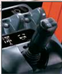
ควบคุม การขับเคลื่อน ง่ายต่อการจับที่ — คันโยกควบคุมที่ผสม การควบคุมด้วยนิ้วมือ
