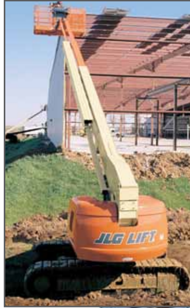
Dòng Bánh xích 600 được trang bị các bánh xích toàn bằng thép.
