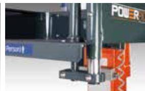
Verrouillage automatique du portillon en élévation
